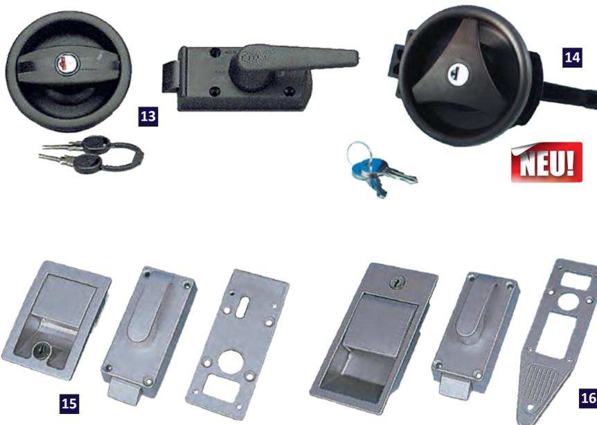
**13. Türschloss rechts.** Einbau- $\varnothing$  92 mm. Komplett-Einheit aus Außenschloss, Innenschloss und zwei Schlüsseln. Für Wandstärke 25 - 35 mm.
