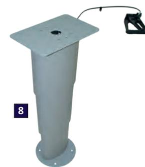
**6. PRIMERO Comfort - HVK.** Mit kleiner Fußplatte und Tischplattenverschiebung (gleitet fast geräuschlos und kann frei positioniert werden, der Klemmhebel ist von zwei Seiten immer leicht zu erreichen). Höhe 345 - 705 mm, Hub 360 mm. Gewicht 10,9 kg. Nr. 91849 335,—
