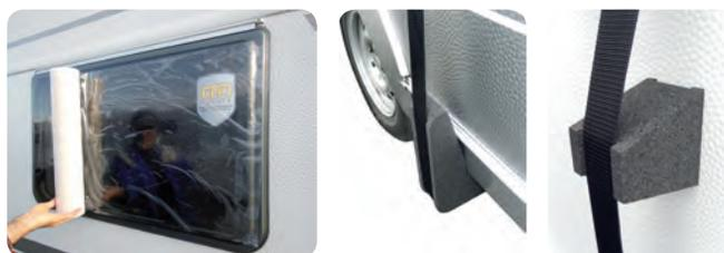
**Ersatzgurte für Schutzhüllen.** Bestehend aus 4 Gurten (240 cm) für Front- und Heckbereich sowie 4 Quergurten (380 cm) für die Fahrzeugunterseite.
