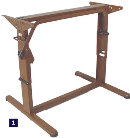
**1. Hubtisch-Automatik HTA.** Das Metallgestell ist trotz seiner Stabilität ein ausgesprochenes Leichtgewicht. Die Tischplattenhöhe kann eingestellt werden. Gewicht 7,4 kg. Betthöhe 310 - 350 mm (ohne Tischplatte), Hub 350 mm. Fußabstand 750 mm.
