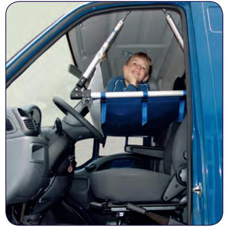
**1. EuroCarry Kinderbett.** Passend für Fiat, Peugeot und Citroen Kastenwagen. Das bequeme EuroCarry Kinderbett ist innerhalb von wenigen Minuten zusammengebaut und wird einfach in die Fahrerkabine gehängt. Um das Bett im Fahrerhaus zu befestigen, werden die Innenraum-Haltegriffe abmontiert und durch Schraubösen ersetzt. In diese Schraubösen wird das Kinderbett mit Sicherheitsschnellverschlüssen eingehängt.
