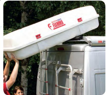
**1. FIXING-BAR PRO L.** 240 cm lange Tragestange aus extrudiertem Aluminium, auf Wunsch kürzbar. Lieferumfang: Profil mit 2 Befestigungselementen, weiß lackiert. Gewicht 1,5 kg. **Nr. 95524 56,50**
