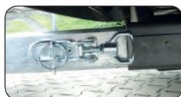
Über die Schnellverschlüsse lässt sich der komplette Träger in wenigen Minuten werkzeuglos abnehmen, wenn er nicht gebraucht wird.
