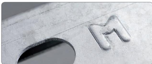
AL-KO-Chassis mit der „M“-Prägung am Längsrahmen (Einachser ab Modelljahr 2010 / Tandemachser ab Modelljahr 2015) verfügen serienmäßig über Aufnahmebohrungen für das MAMMUT-System.
