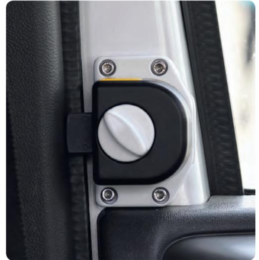
**HEOSafe** Türsicherung für Fahrerhaustüren montiert am Türrahmen mit Edelstahl-Blechschauben. Riegel greift hinter den Rahmen, für eine fettfreie Funktion sorgt eine spezielle Gliss-Coat Beschichtung.
